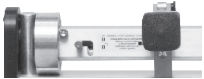
INMOVILIZADOR DE LEVA EN POSICIÓN BLOQUEADA
