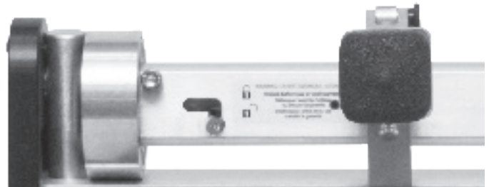
INMOVILIZADOR DE LEVA EN POSICIÓN DESBLOQUEADA
