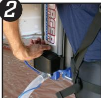
Pour effectuer un nettoyage plus complet, ouvrir la commande de débit d'enduit à son maximum et pulvériser tout le reste d'enduit dans un seau.
