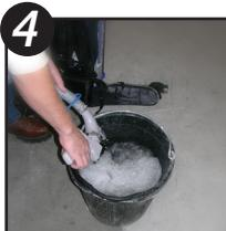
Vuelva a instalar el pistón y la tapa y rocíe agua limpia a través de ellos. Repita los pasos 3 y 4 hasta que el agua rociada salga transparente. Extraiga la pistola y friegue la misma si fuera necesario. No instale la tapa y la pistola en una unidad mojada para reducir la acumulación de moho. Vuelva a lubricar los sellos del pistón y las juntas tóricas de la tapa después de la limpieza. Ahora la ENFORCER™ está lista para el próximo trabajo.
