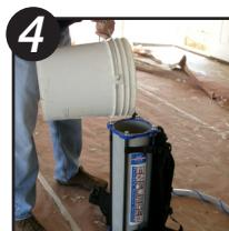
4 Ensuite, remplir le réservoir aux ¾ d'enduit pour cloison sèche en le versant dans l'orifice du capuchon. Placer le piston dans le réservoir et l'enfoncer jusqu'à ce qu'il repose sur le dessus de l'enduit. Un léger mouvement de rotation ou d'oscillation peut être nécessaire pour libérer l'air piégé entre le piston et l'enduit.
