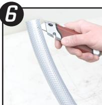
Haga un corte de 1/2 pulg. (13 mm) de profundidad a lo largo de un extremo de la manguera de llenado y conecte este extremo de la manguera de llenado a la salida de la bomba de pasta. Apriete la abrazadera con un destornillador.
