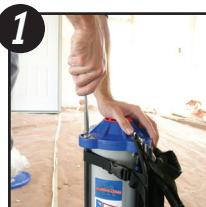
1 Pour déposer le capuchon supérieur, commencer par desserrer les boulons supérieurs de 1 à 2 tours.
