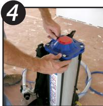
Pour déposer le capuchon, commencer par desserrer les boulons supérieurs de 1 à 2 tours. Ensuite, tout en tenant le loquet rouge en position haute, tourner le capuchon vers la gauche jusqu'à la butée. Soulever le capuchon pour l'enlever.
