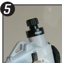
5 Une fois que le système est plein, détacher le tuyau du raccord de remplissage du tuyau. Bien remettre le capuchon en place sur le bouchon d'orifice supérieur du pistolet
