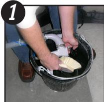
Se debe limpiar el orificio de la pistola después de cada uso. Para obtener los mejores resultados, separe la pistola y la placa selectora de orificios y enjuague cada una de ellas con agua limpia.
