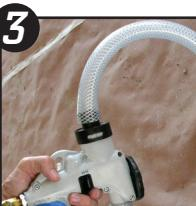
3 Attacher le bout du tuyau de remplissage au raccord de remplissage du pistolet.
