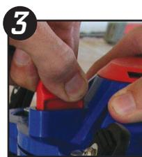
Tire hacia arriba del dispositivo de desbloqueo rojo para dejar salir la presión de aire acumulada. Asegúrese de que haya escapado toda la presión de aire antes de continuar con el paso siguiente.
