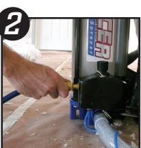
Conecte la manguera del compresor de aire en la entrada de aire macho en el ensamblaje neumático. Establezca el compresor de aire en 40 psi y ajústelo si fuera necesario. NO EXCEDA LOS 120 PSI. HACERLO PODRÍA CAUSAR LESIONES GRAVES.
