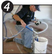
Bombee pasta desde la cubeta hasta la ENFORCER. El número de bombeos requerido para llenar el tanque variará en función de la viscosidad del material y de las carreras
