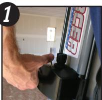
Asegúrese de que el interruptor de palanca de llenado/rociado esté en la posición de FILL/OFF (LLENADO/APAGADO) y de que el control de flujo de la pasta se haya girado completamente en la dirección contraria a las manecillas del reloj. Finalmente, asegúrese de que el control de flujo de aire de la pistola se haya girado hasta la posición de apagado.
