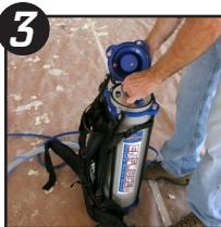
Extraiga el pistón apretando el gatillo de la pistola y tirando de la empuñadura del pistón hacia arriba.
