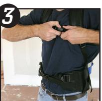
Une fois le tuyau du compresseur d'air raccordé, mettre le sac sur le dos. Les bretelles offrent plusieurs réglages pour assurer un ajustement ferme et confortable.
