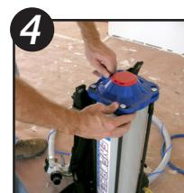
Para quitar la tapa superior, empiece aflojando 1 a 2 giros los tornillos superiores. A continuación, mientras sujetá el dispositivo de desbloqueo rojo hacia arriba, gire la tapa superior en el sentido contrario de las manecillas del reloj hasta que se detenga. Levante la tapa para extraerla.
