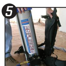
Fije el ensamble de la manguera de pasta en la salida del tanque. Enrosque el adaptador de la manguera de pasta en la tapa inferior hasta que quede apretada.
