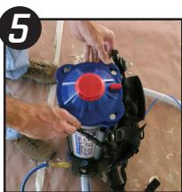
Vuelva a colocar la tapa superior sobre el tanque colocándola sobre los tornillos superiores y enroscándola en el sentido de las manecillas del reloj.
