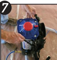
Remettre le capuchon en place sur le réservoir en le plaçant sur les boulons et le tourner vers la droite. Une fois le capuchon bien en place, rabaisser le loquet pour assurer une fermeture étanche. Serrer les boulons supérieurs comme il se doit.
