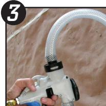
Coloque el extremo de la manguera de llenado sobre el adaptador de llenado de la pistola.
