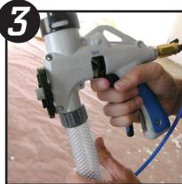
3 Attacher le tuyau à enduit au raccord d'admission inférieur du pistolet. Serrer à la main. NE PAS FORCER.
