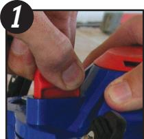
Invierta el interruptor de palanca de llenado/rociado a la posición de **FILL** (**LLENADO**). Asegúrese de que se libere toda la presión del aire del tanque antes de que se inicie el llenado. Usted sabrá que lo ha logrado cuando deje de salir aire del ensamble neumático.
