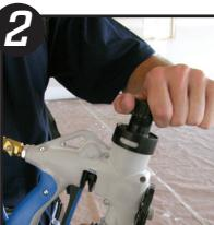
2 Ensuite, enlever le capuchon sur le bouchon d'orifice supérieur du pistolet en le tournant vers la gauche. Amorcer la pompe jusqu'à ce que le tuyau de remplissage soit rempli d'enduit. **Cette étape est essentielle pour éviter l'injection d'air dans le réservoir, ce qui produirait des textures irrégulières.**
