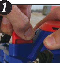
1 Placer le commutateur de remplissage/pulvérisation en position FILL. Veiller à libérer toute la pression d'air du réservoir avant de débuter le remplissage. Cela est accompli lorsque l'air cesse de s'échapper du système pneumatique.
