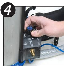
Cuando la mochila esté en una posición segura y cómoda, invierta el interruptor de palanca de llenado/rociado a la posición de SPRAY (ROCIADO) y ajuste el flujo de aire de la pistola abriendo la válvula de globo en la base de la pistola.
