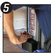
Mientras mantiene presionado el gatillo de la pistola, empiece a ajustar el flujo de pasta. Sólo tiene que levantar y girar el control de flujo de la pasta en la dirección de las
