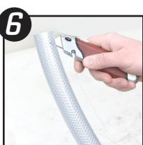
6 Couper un bout du tuyau de remplissage sur 13 mm dans le sens de la longueur et raccorder ce bout du tuyau à la sortie de la pompe à enduit. Serrer le collier au tournevis.
