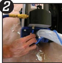
2 Enfoncer le tuyau d'air spiralé bleu pour l'enclencher dans le raccord poussoir au bas du capot du système pneumatique.
