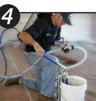
4 Pomper l'enduit depuis un seau dans l'ENFORCER. Le nombre de coups de pompe nécessaire pour remplir le réservoir dépend de la viscosité de l'enduit et de la course de la pompe, mais se situe typiquement aux environs de 20 à 25 coups. Lorsque l'ENFORCER™ est plein, le pompage devient nettement plus difficile. Arrêter alors de pomper. **NE PAS FORCER LE POMPAGE. CECI POURRAIT PROVOQUER UNE DÉFAILLANCE MATÉRIELLE ET DES BLESSURES GRAVES.**
