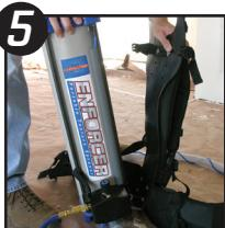
5 Poser le dessous du réservoir sur la barre de support du sac à dos et attacher les sangles. Serrer les sangles de manière à obtenir un maintien ferme.
