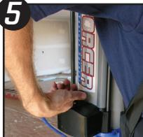
Tout en tenant la gâchette du pistolet enfoncée, régler le débit d'enduit. Il suffit de soulever et de tourner la commande de débit d'enduit, vers la droite pour augmenter le débit, vers la gauche pour le réduire. Pulvériser éventuellement l'enduit initial dans un seau ou sur un morceau de rebut de matériau. Une fois que le débit souhaité est obtenu, renfoncer la bague extérieure du bouton de réglage pour le verrouiller.
