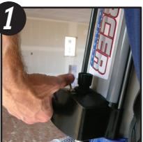
Vérifier que le commutateur de remplissage/pulvérisation est en position FILL/OFF et que la commande de débit d'enduit est tournée à fond vers la gauche. Enfin, vérifier que la commande de débit d'air sur le pistolet est en position fermée.
