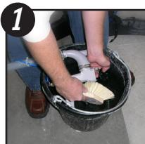
1 La sortie du pistolet doit être nettoyée après chaque utilisation. Pour bien les nettoyer, séparer le pistolet et le disque de sortie et les rincer à l'eau claire.
