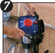
Vuelva a colocar la tapa superior sobre el tanque colocándola sobre los tornillos superiores y enroscándola en el sentido de las manecillas del reloj.
