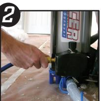
Raccorder le tuyau du compresseur d'air à l'entrée pneumatique mâle du système. Régler le compresseur sur 40 psi et ajuster le cas échéant. NE PAS DÉPASSER 120 PSI. CECI POURRAIT RÉSULTER EN DES BLESSURES GRAVES.
