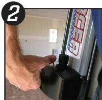
Placer le commutateur de remplissage/pulvérisation en position FILL.
