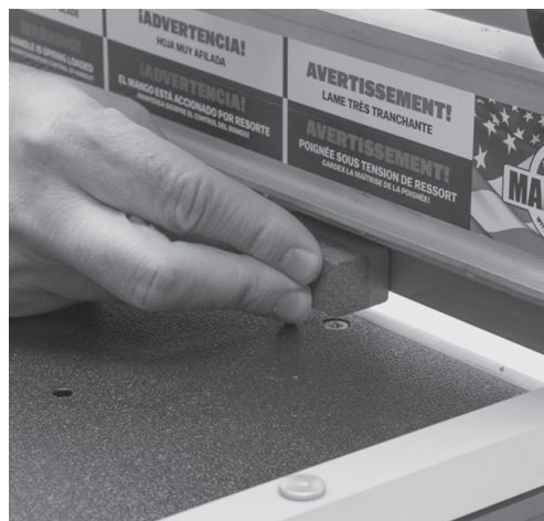
Abgeschrägte Messerkante zeigt auf Halteschrauben
