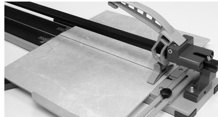
3. Despues de marcar, y sin mover la loseta, coloque el mango de manera que la pata de corte esté directamente encima del borde delantero de las losetas (en el tope).
