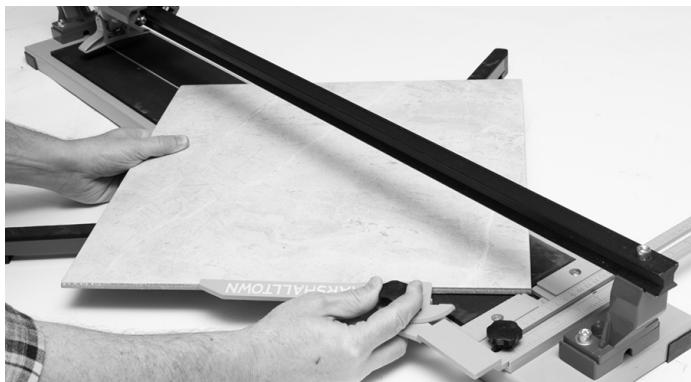
1. Ajuste la guía de ángulos al ángulo deseado y coloque la guía contra la loseta.
