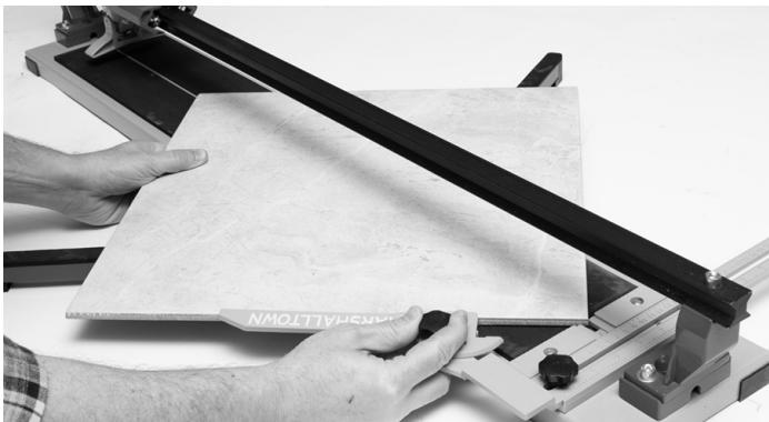
1. Régler le guide d'angle à l'angle souhaité et placer le carreau contre le guide.
