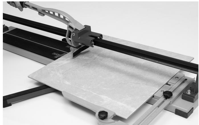
1. Régler le rapporteur d'angle en fonction de la dimension du carreau et placer le carreau dans la position la plus en avant possible sur le coupe-carreau contre la butée.
