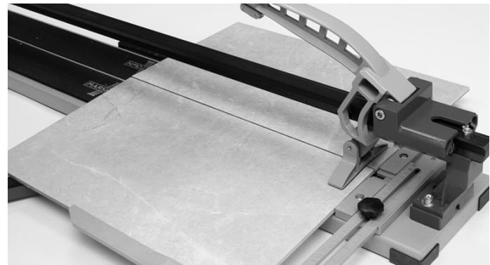
3. Une fois l'entaille effectuée, et sans déplacer le carreau, placer le manche de telle façon que le sabot de cassure soit directement au-dessus du bord avant du carreau (contre la butée).
