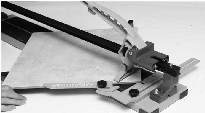
3. Voltee la quebradora hacia abajo y posíónela ligeramente alejada del borde delantero de la loseta.
