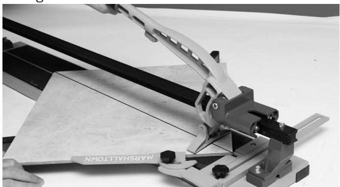
4. Appliquer une pression progressive sur le levier jusqu'à ce que le carreau se casse.
