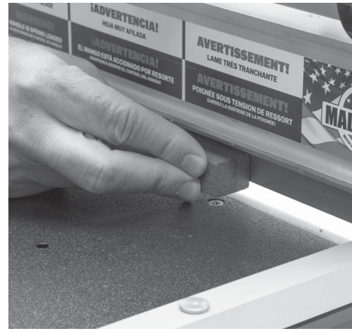
Borde biselado de la hoja orientado hacia los tornillos de retención
